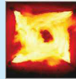
Charakter przepływu w palenisku tangencjalnym
